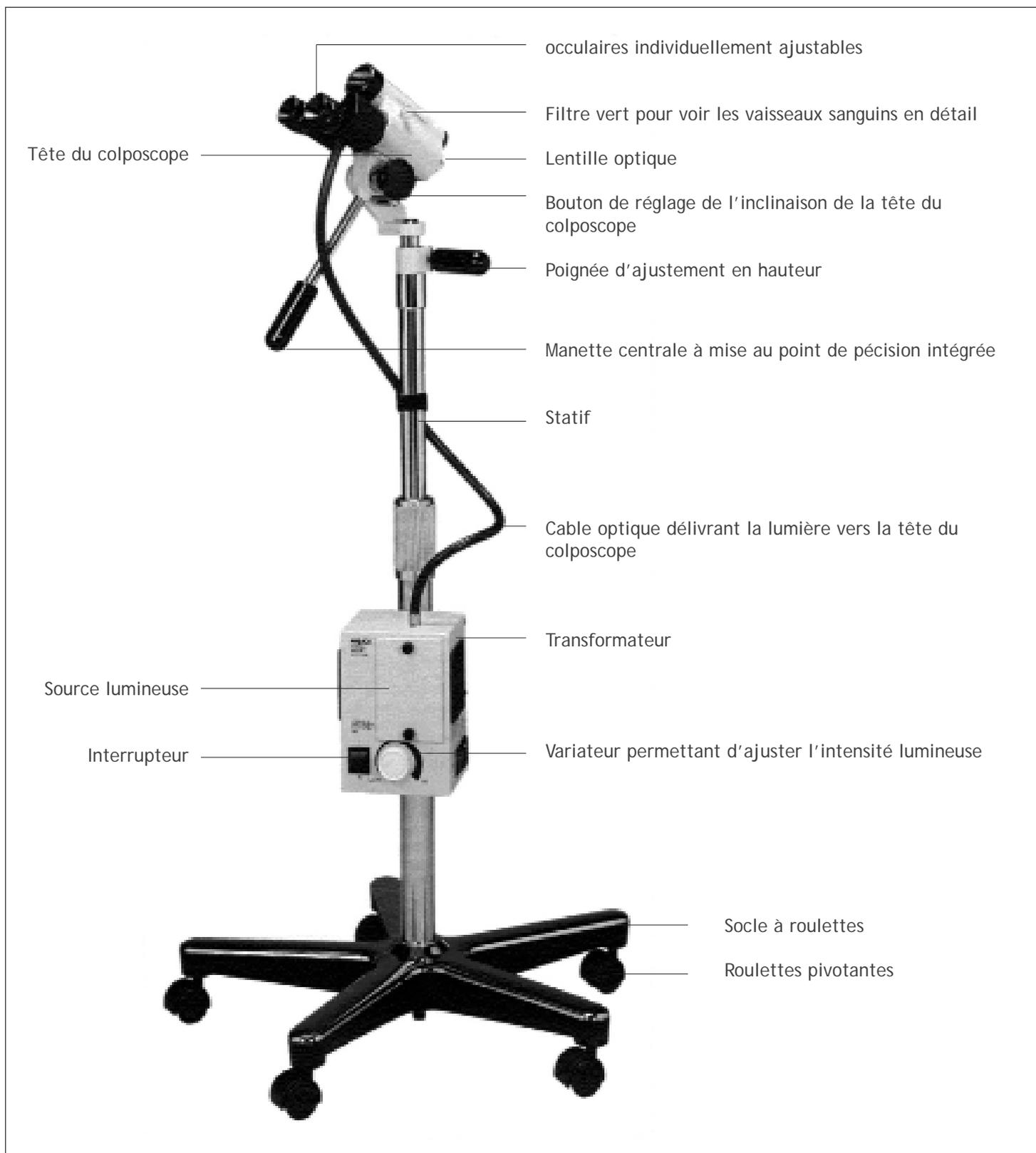
FIGURE 4.1 : Colposcope
