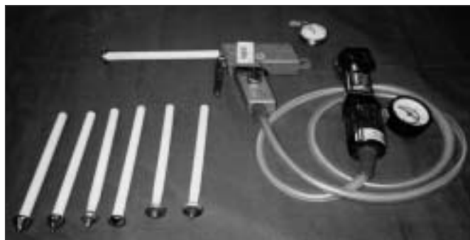
FIGURA 12.1: Criosondas, aplicador, manómetro y cronómetro.
