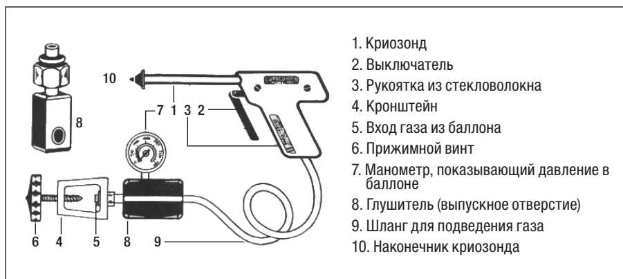
Рисунок ПР 12.1. Устройство аппарата для криодеструкции.
