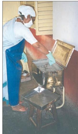
**FIGURE 17.** Autoclave : stérilisation à la vapeur sous pression
