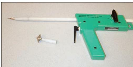
métallique; d'un manomètre pour régler le débit de gaz; et d'un tuyau qui transporte le gaz jusqu'à la sonde cryogénique. Un système de base sera équipé d'une gâchette que l'opérateur actionnera pour laisser circuler le gaz à travers le tube et l'embout de la sonde cryogénique.
