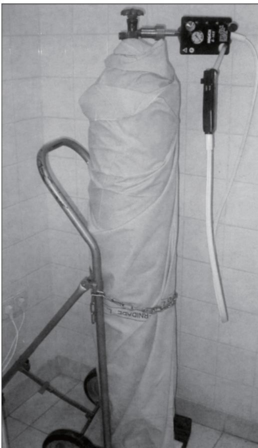
图 12.4 冷冻仪器设备与大气筒连接，气筒表面用清洁的布覆盖，并安全地放置在可移动的推车上
